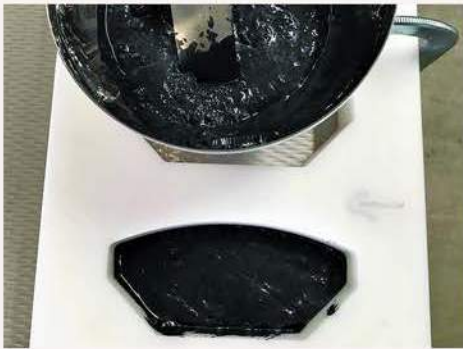
Exemplarisches Füllen einer Form
